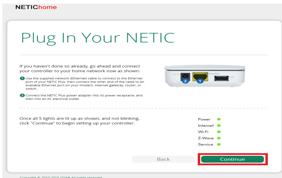
Рис. 5. Подключение контроллера к сети Ethernet.
